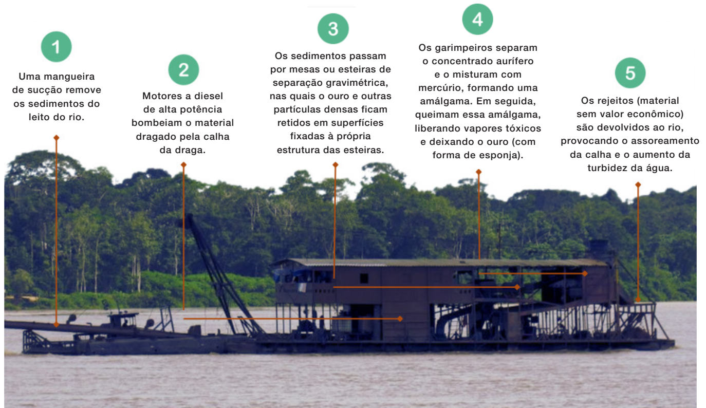
Figura 4. Processo de mineração aluvial de ouro
